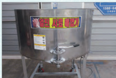
사료 배합기 Mollar uchun yem-xashakni aralashirish apparati 사료 배합기에 사료를 투입합니다. Mollar uchun yem-xashakni aralashirish apparatiga yem-xashaklar solinadi.
